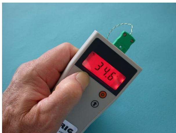
Eine glasfaserisolierte 1 meter CelsiProbe® K-Sonde #10826 wird mittels Miniaturthermostecker am CelsiMeter® KC-1000 angeschlossen.
