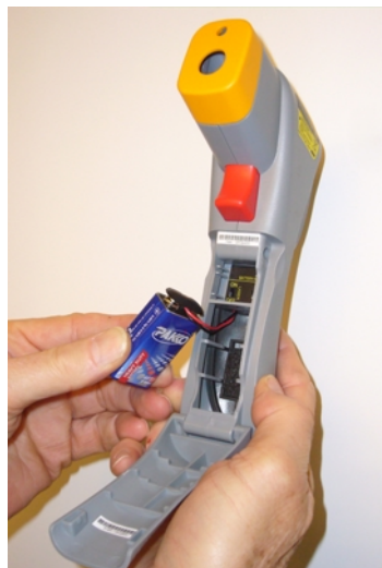
Mitgelieferte 9-Volt Batterie einsetzen. Schiebeschalter im Batteriefach auf ON oder OFF stellen. Schiebeschalter auf °C oder °F stellen.
