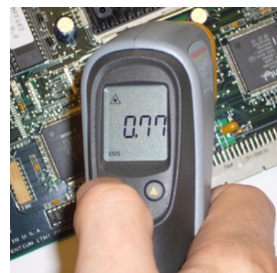
Beim CMI-056V kann der EM-Faktor von 0.10 bis 1.00 eingestellt werden. Der Wert wird automatisch gespeichert.
